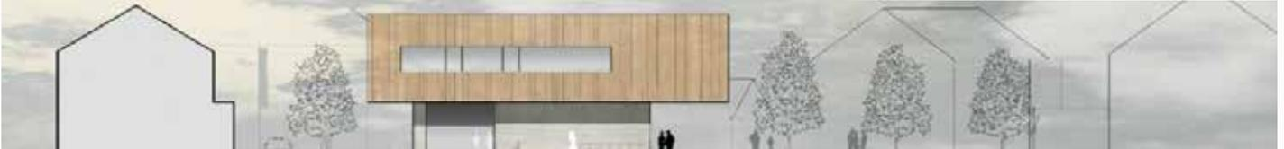
Das Amtsgebäude stellt einen Skelettbau dar, bestehend aus Stahlbeton-Stützen als Sockel und einen Trägerrost aus Holzleimbindern.
